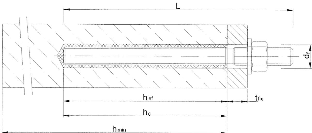
VEBATEC Injektionsmörtel Premium Z4 mit Ankerstange 5.8
