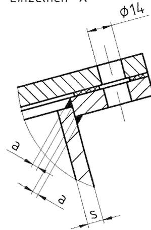
wahlweise : a ) Losdeckel mit Durchgangsschrauben M 12
