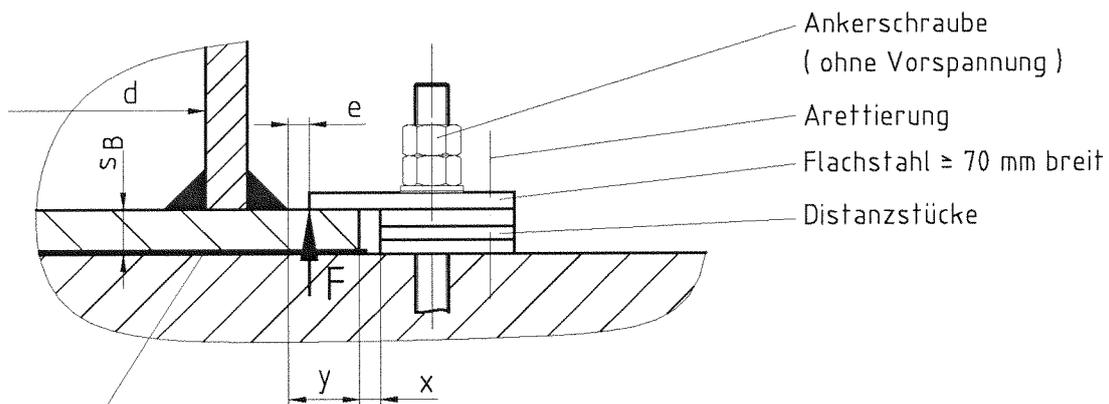
PE - Zwischenplatte  $\geq 2$  mm
