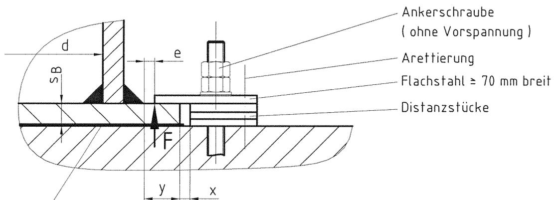
PE - Zwischenplatte  $\geq 2$  mm
