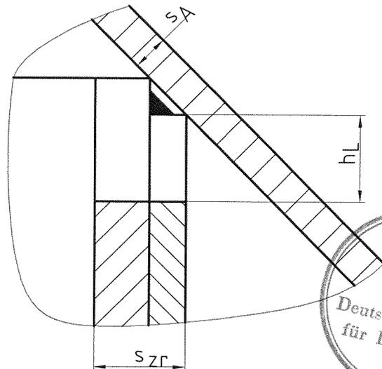
$s_{Zr}$  = Randdicke der Auffangvorrichtung (Anlage 1.1)
