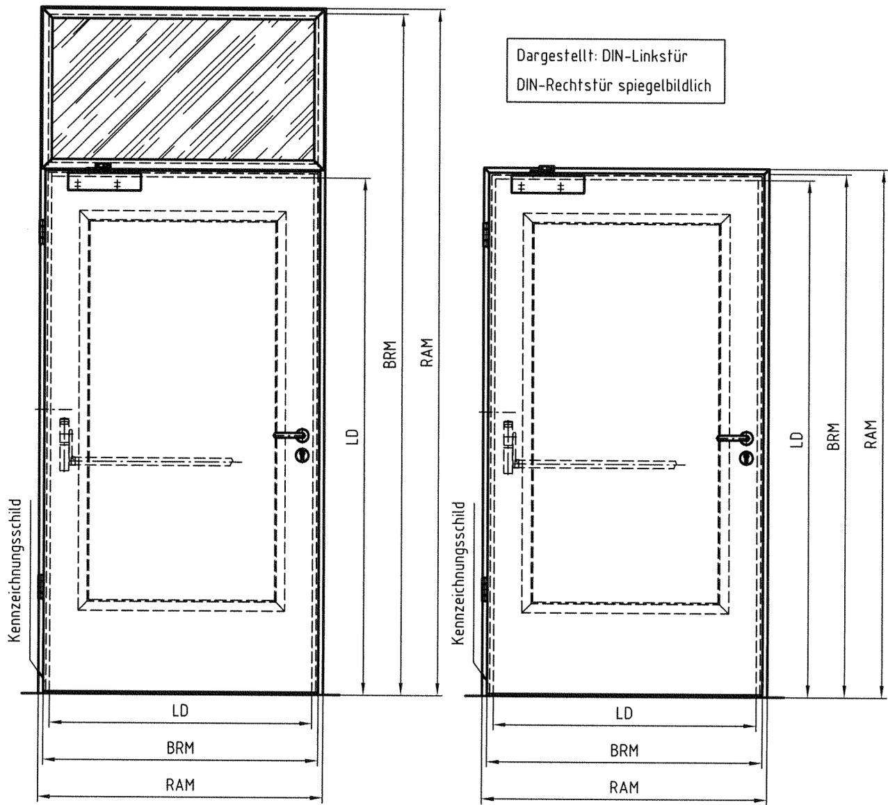
T30-1-RS-Tür immer mit absenkbarer Bodendichtung oder mit 4-seitig umlaufender Zargendichtung ausführen. Den Wandanschluss der Zarge immer beidseitig versiegeln!
