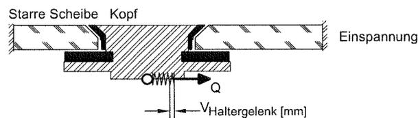
Steifigkeit bei Querkrafteinwirkung  $342 \text{ N/mm} \leq C_Q$  \*
