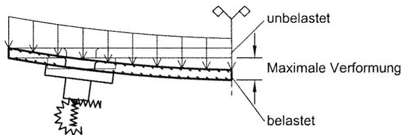
$C_M, C_{x,y}, C_z$  : Zusätzliche Lagersteifigkeit für die Modellverifizierung
