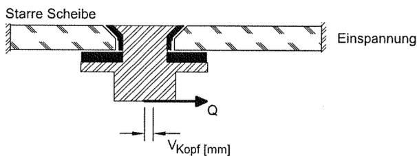
$$\text{Steifigkeit bei Querkrafteinwirkung } 2.707 \text{ N/mm} \leq C_Q^*$$
