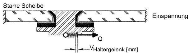
Steifigkeit bei Querkrafteinwirkung  $310 \text{ N/mm} \leq C_Q$  \*
