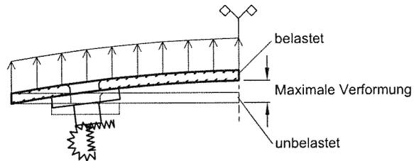
$C_M, C_{x,y}, C_z$  : Zusätzliche Lagersteifigkeit für die Modellverifizierung
