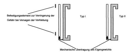
Abbildung 1 – Schematische Darstellung von Beispielen der verschiedenen Arten von Bausätzen für geklebte Glaskonstruktionen
