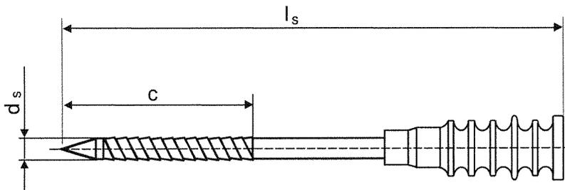
Nagel mit aufgespresstem Kunststoffkopf (PA)
