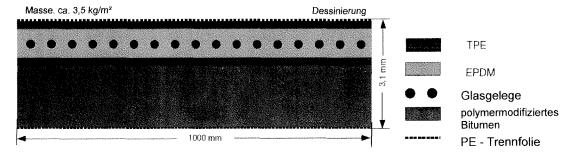
Bitumen – verträgliche, heißluft verschweißbare EPDM-Synthesekautschukabdichtungsbahn
