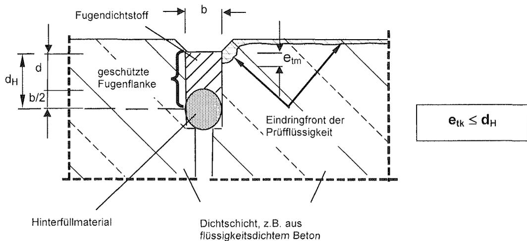
$d_H$  = Haft- bzw. Kontaktfläche des Fugendichtstoffes an der Fugenflanke;  $d_H = d + b/2$
