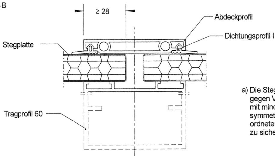
a) Die Stegplatten sind gegen Verschiebung mit mindestens zwei symmetrisch angeordneten Schrauben zu sichern.
