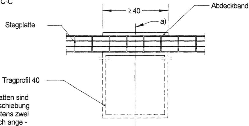
a) Die Stegplatten sind gegen Verschiebung mit mindestens zwei symmetrisch angeordneten Schrauben zu sichern.
