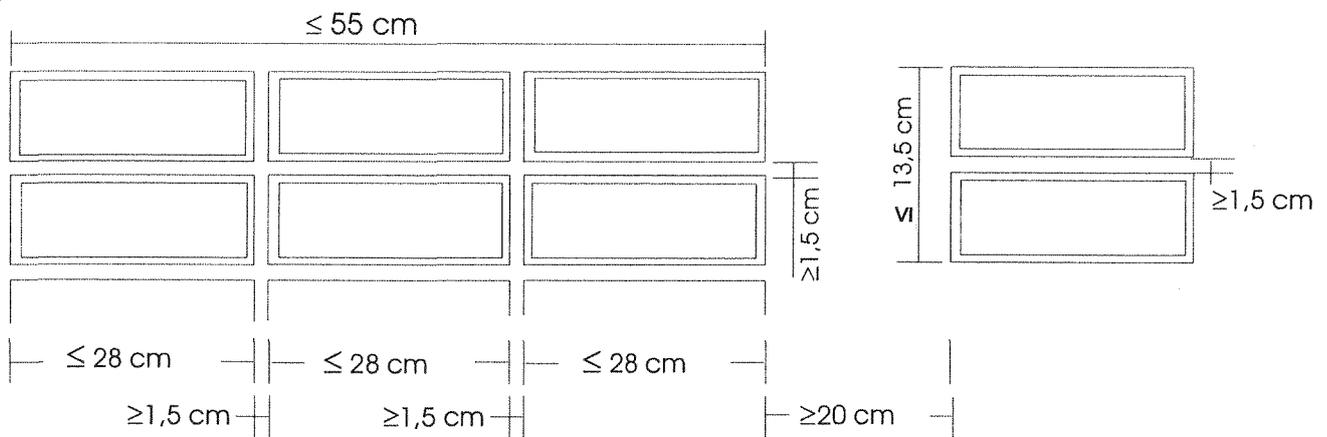
Kabelabschottung "Würth-Kabelbox kurz" der Feuerwiderstandsklasse S30 bzw. S90 nach DIN 4102-9 - Prinzipdarstellung und Gruppeneinbau in Wände mit Mörtel und Gipsfugenfüller-
