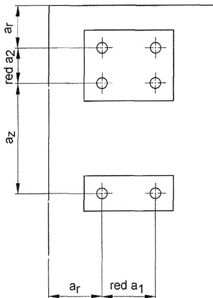
Reduzierte zulässige Lasten bei reduzierten Achsabständen je Dübel, bei Dübelgruppen mit  $\min a \leq \text{red } a < a$  (siehe Abschnitt 3.2.2.1).
