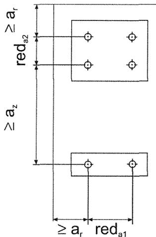
Reduziert zulässige Lasten bei reduzierten Achsabständen je Dübel bei Dübelgruppen
