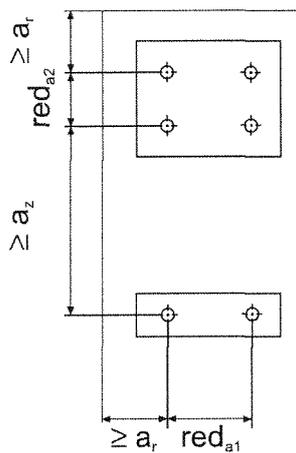
Reduziert zulässige Lasten bei reduzierten Achsabständen je Dübel bei Dübelgruppen
