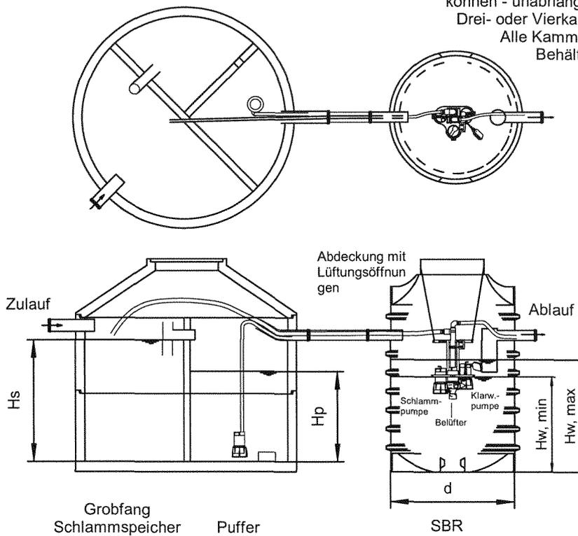
Behälter für Grobfang / Schlamm-speicher und Puffer können - unabhängig voneinander - als Ein-/Zwei-/Drei- oder Vierkammergruben ausgebildet sein. Alle Kammern können als separate Behälter ausgeführt sein.
