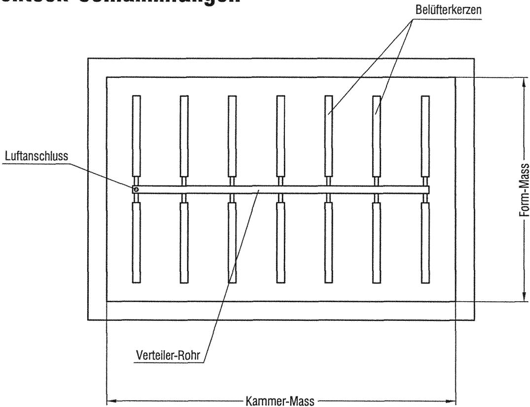
typische Hauptmasse handelsüblicher Rechteckschlammfänge in Ein- und Mehrkammer-Bauweise
