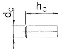
Verschlussstopfen (zum Verschließen des Dübeltellers)
