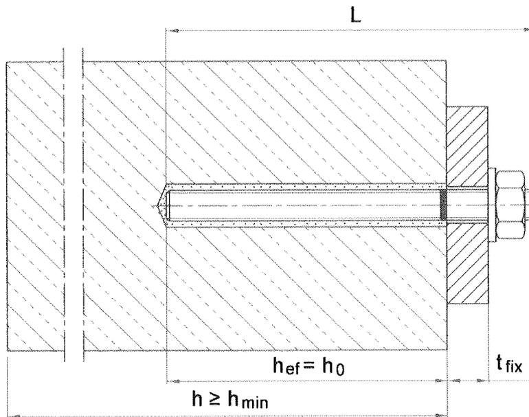
Nutzungskategorie: Ungerissener Beton, Montage im trockenen oder feuchten Beton, oder im wassergefülltem Bohrloch
