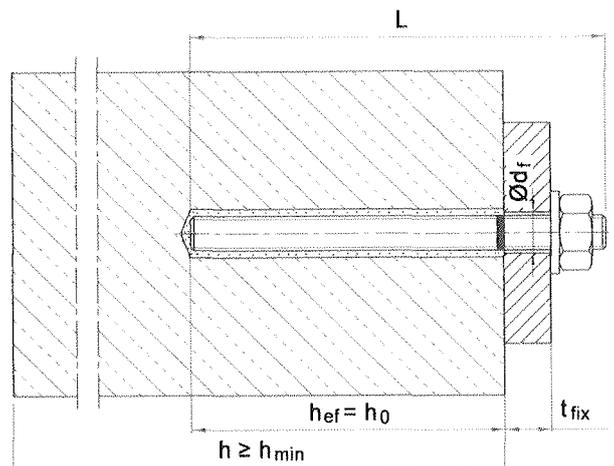
**MKT Injektionssystem VMU für Beton****Anhang 5****Montagekennwerte,
