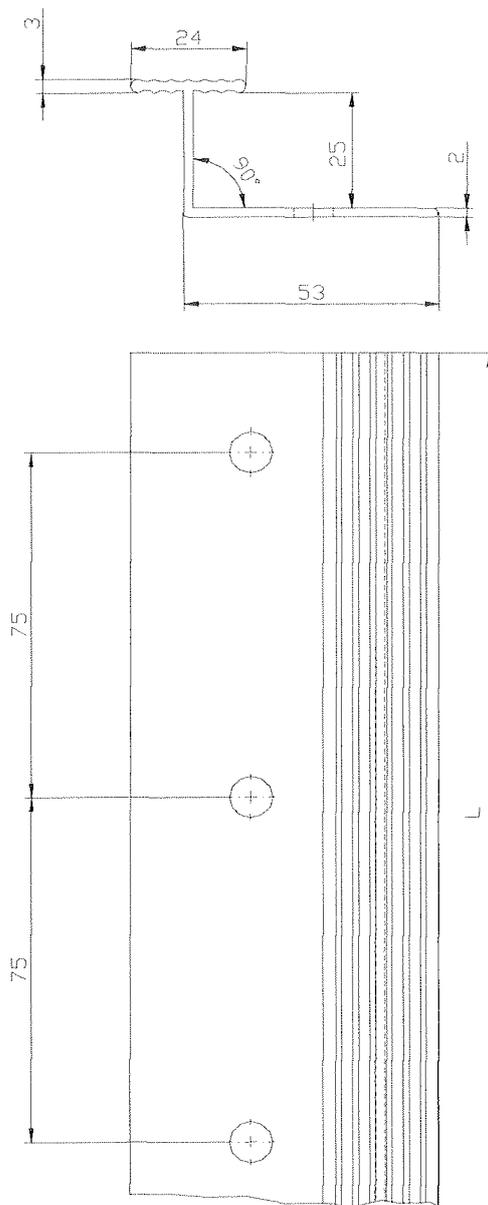
**Vertikales Verbindungsprofil – "villerit Verbindungsschiene" (Abmessungen in Millimetern)**
