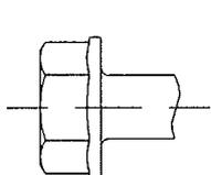
Ausführung mit angepresster Scheibe und Sechskantkopf,
