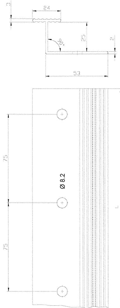
**Vertikales Verbindungsprofil "Verbindungsleiste PVC" (Maße in mm)**
