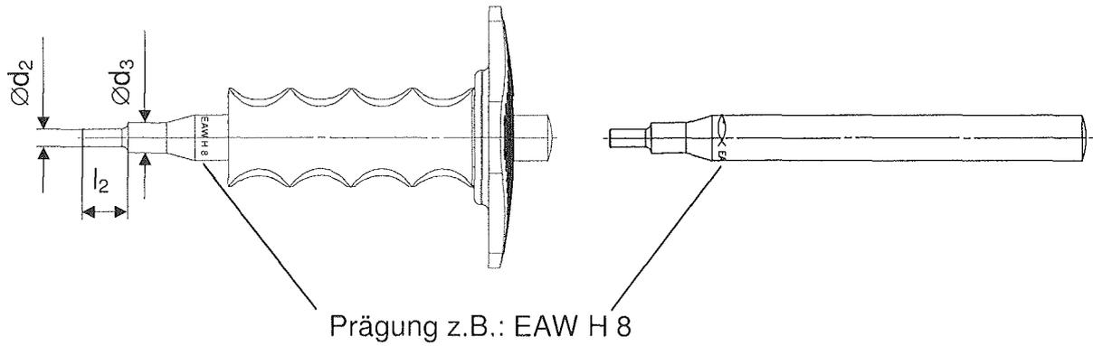
Montagekontrolle mit Handsetzwerkzeug EAW H oder EAW H Plus
