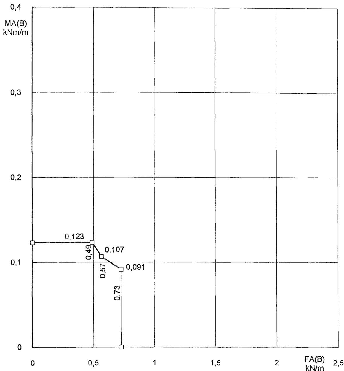
**Zulässiges Biegemoment MA(B) bei zulässiger Auflagerkraft FA(B)
