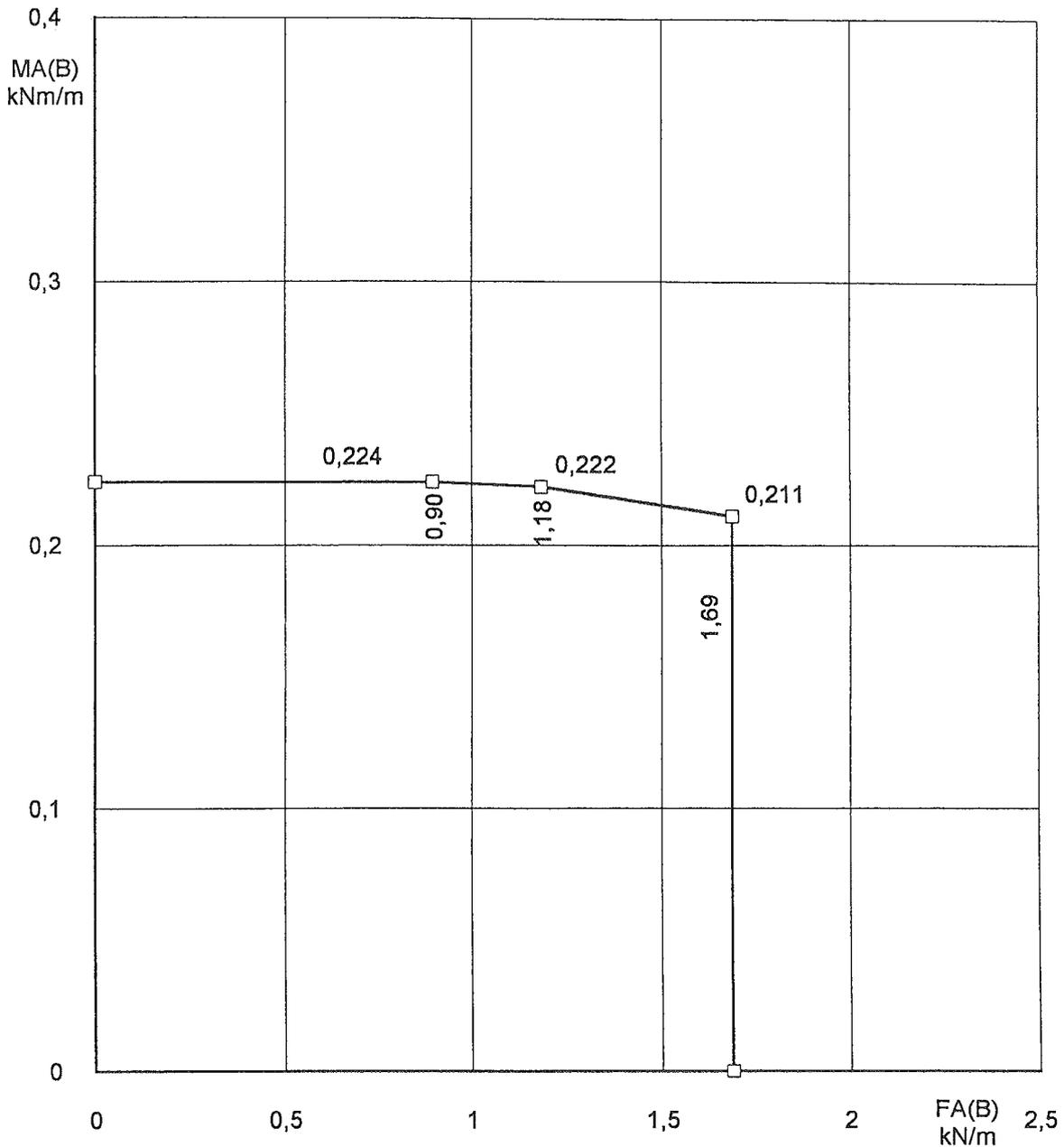
**Zulässiges Biegemoment MA(B) bei zulässiger Auflagerkraft FA(B)
