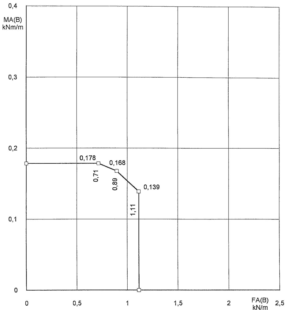
**Zulässiges Biegemoment MA(B) bei zulässiger Auflagerkraft FA(B)
