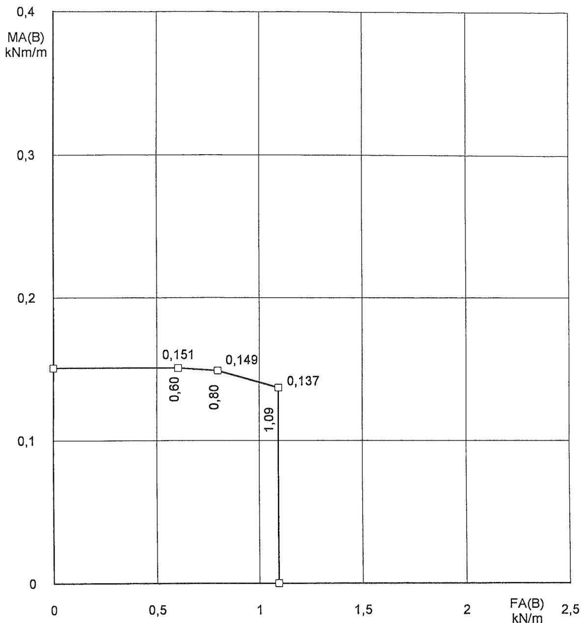
**Zulässiges Biegemoment MA(B) bei zulässiger Auflagerkraft FA(B)
