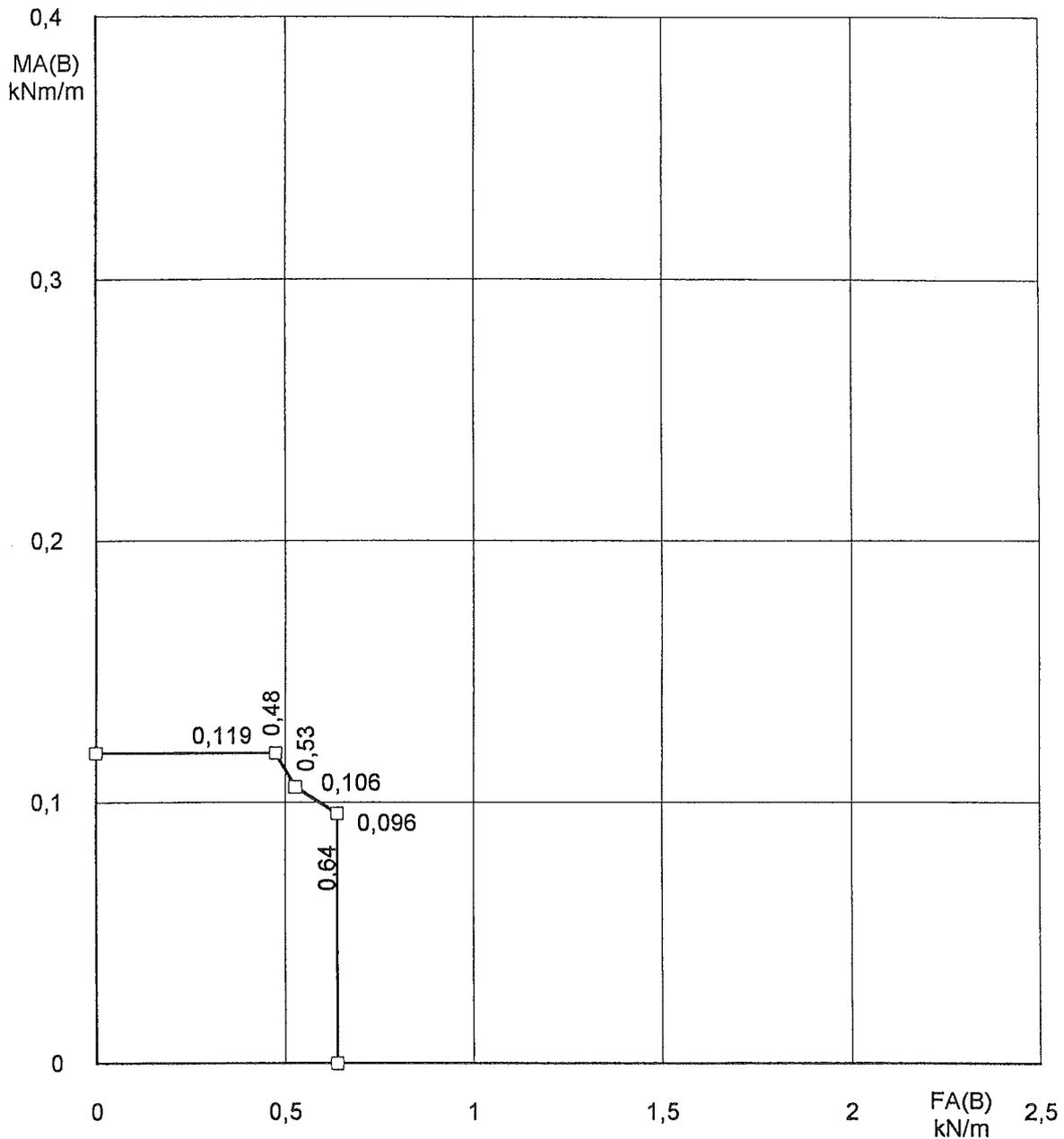
**Zulässiges Biegemoment MA(B) bei zulässiger Auflagerkraft FA(B)
