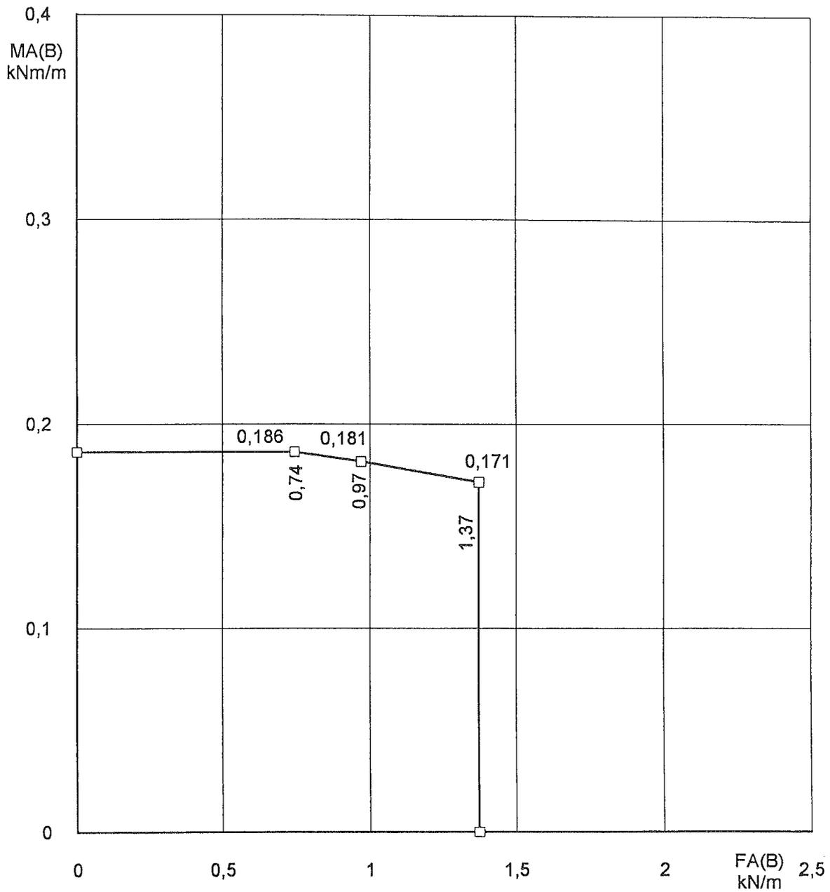
**Zulässiges Biegemoment MA(B) bei zulässiger Auflagerkraft FA(B)
