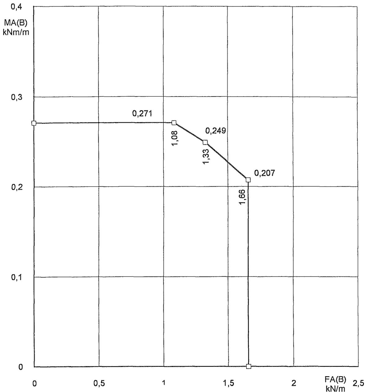
**Zulässiges Biegemoment MA(B) bei zulässiger Auflagerkraft FA(B)
