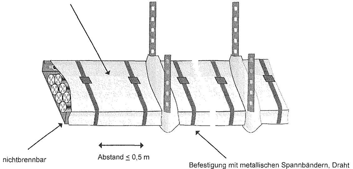
Einbausituation mit äußerer Brandschutzumhüllung und Abstand zwischen Brandschutzumhüllung und der Kabeloberfläche  $> 40$  mm
