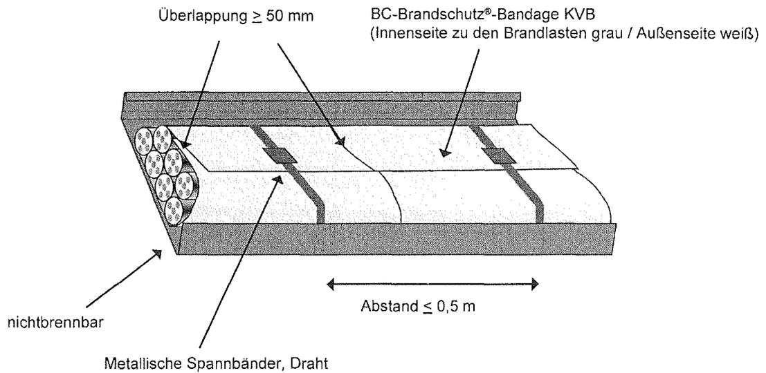
Einbausituation äußere Brandschutzumhüllung bei Steigetrassen
