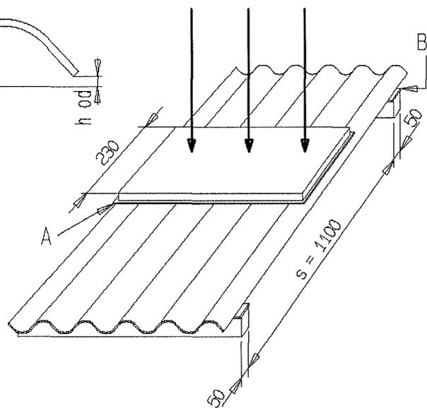
Bild 11: Belastungsanordnung für die Prüfung der Biegefestigkeit
