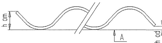
Bild 9: Bestimmung der Kantenhöhe
