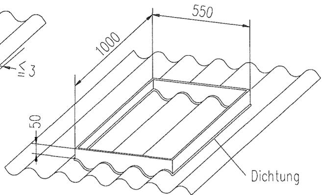
Bild 8: Prüfanordnung zur Bestimmung der Wasserundurchlässigkeit
