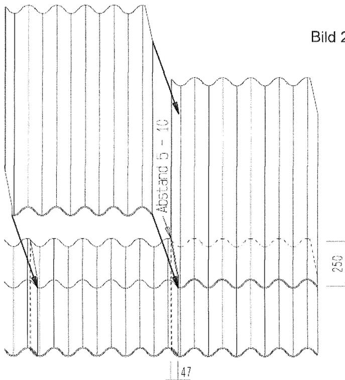
Bild 3: Überdeckung und Eckschnitte
