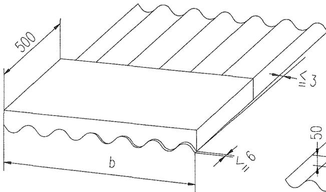
Bild 7: Prüfanordnung zur Bestimmung der Rechtwinkligkeit
