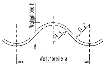
Bild 10: Wellenquerschnitt
