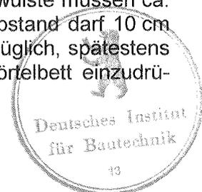
Bei Verwendung von Dämmstoffplatten aus Polystyrol-Hartschaum nach Abschnitt 2.2.2.1 darf der Klebemörtel auch wulstförmig auf den Untergrund aufgetragen werden. Es müssen mindestens 60 % der Fläche durch Mörtelstreifen bedeckt sein, der Abstand der Kleberwülste darf 10 cm nicht überschreiten. Die Dämmstoffplatten sind unverzüglich, spätestens nach 10 Minuten, in das frische Klebemörtelbett einzudrücken, einzuschwimmen und anzupressen.
