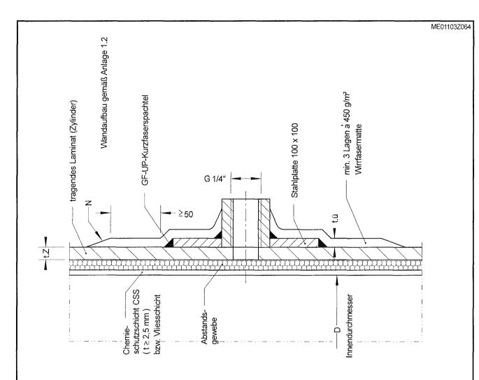
Die Darstellung zeigt den Anschluss für die Messleitung. Dieser Anschluss ist oberhalb des Flüssigkeitspiegels anzuordnen.
