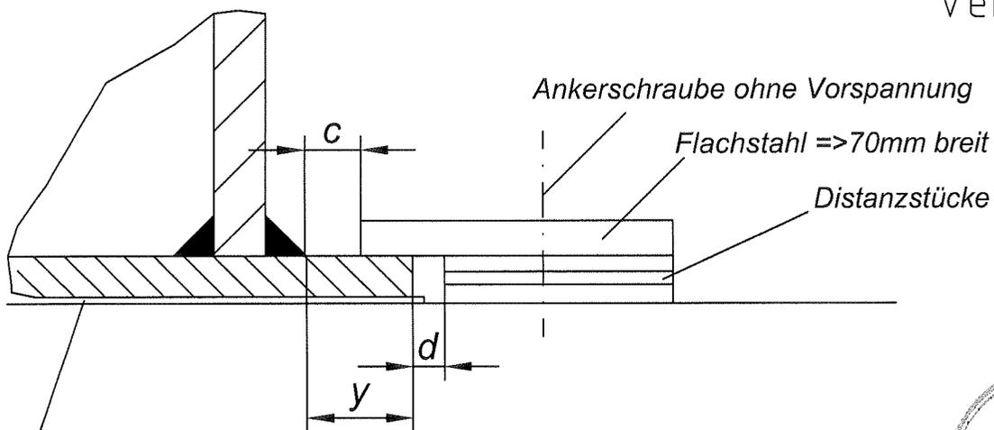
PE-Zwischenplatte  $\Rightarrow$  2mm dick
