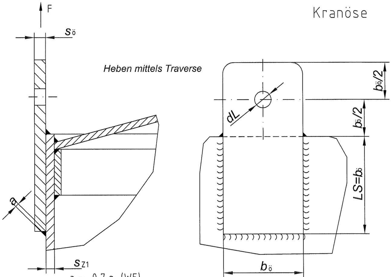
Heben mittels Traverse
