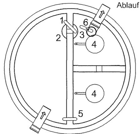
$\text{Schlammabsetzraum} + \text{Aufstaubereich} = \text{max. Belebungsvolumen}$
