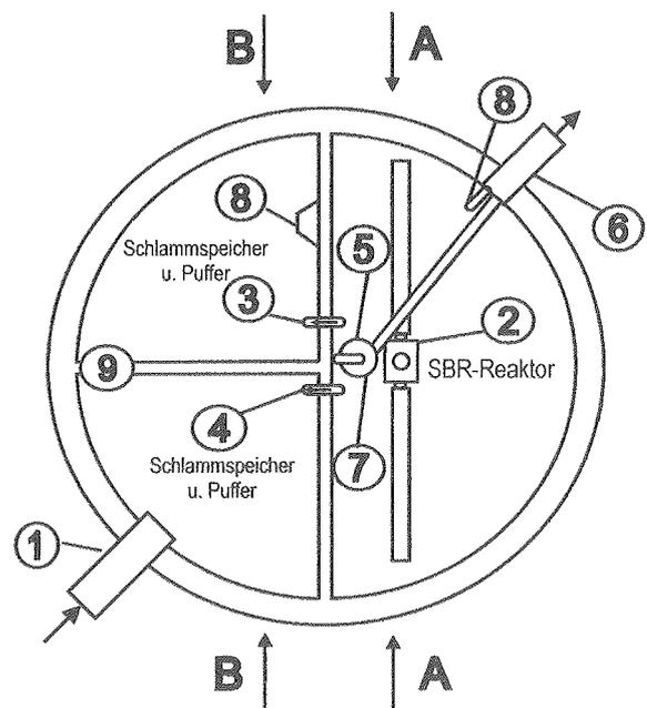
Kläranlagen Typ batchpur bestehen aus einem oder mehreren Behältern nach gleichem Klärtechnischem Aufbau. Anzahl, Einbauort und konstruktive Gestaltung der Komponenten können variieren und an die Behältergeometrie angepasst werden.
