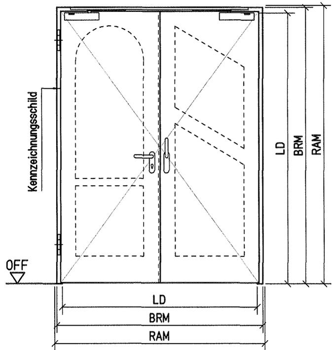
T90-1-RS-Tür und T90-2-RS-Tür immer mit Bodendichtung oder 4-seitiger Zarge ausstatten und bei Wandanschlüssen immer beidseitig versiegeln!
