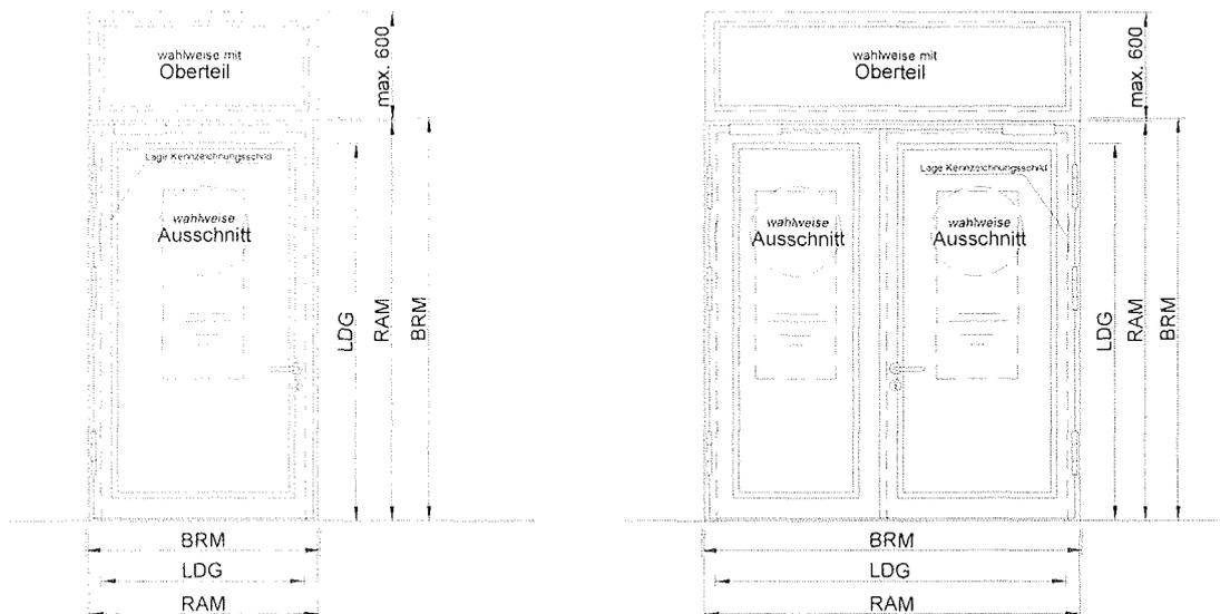
Einfachflügel dargestellt: Anschlagrichtung DIN links
