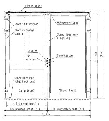
X Bei Verwendung eines Falztreibniegels steht der LD-Gangflügel nur als Rettungsweg zur Verfügung. Dieses Maß verningert sich bei einem Öffnungswinkel von nur 90 Grad.
