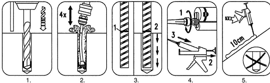
1. Bohrloch mit Hammer- oder Pressluftbohrer erstellen. Bohrerdurchmesser siehe Anhang 6, Tabelle 5.
