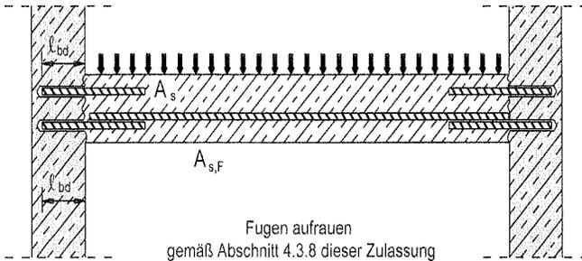
**Bild 4: Bewehrungsanschlüsse überwiegend auf Druck beanspruchter Bauteile**
