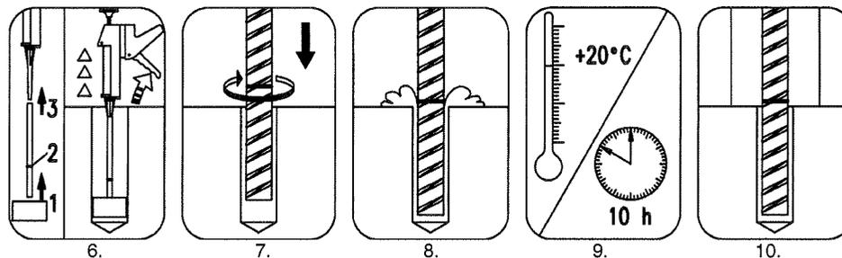
6. Kartusche mit Statikmischer, Mischerverlängerung und Injektionsadapter vorbereiten. Mischerverlängerung muss der Bohrlochtiefe entsprechen. Injektionszubehör gemäß Anhang 6, Tabelle 5 wählen. Markierung an Mischerverlängerung gemäß Anhang 7, Gleichung 1 anbringen. Injektionsmörtel WIT-PE 500 vom Bohrlochgrund luftblasenfrei injizieren.
