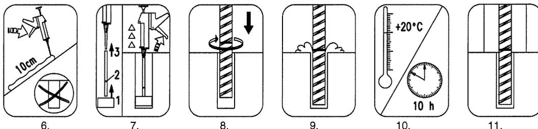
6. Vor der Anwendung einen ca. 10 cm langen Strang (Mörtelvorlauf) auspressen, bis der Mörtel gleichmäßig gefärbt ist. Mörtelvorlauf nicht verwenden!
