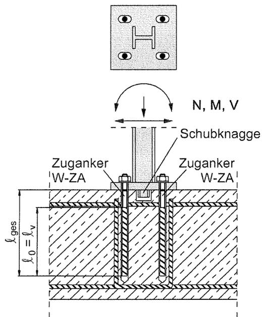
**Bild 7: Übergreifungsstoß für die Verankerung von Geländerpfosten**
