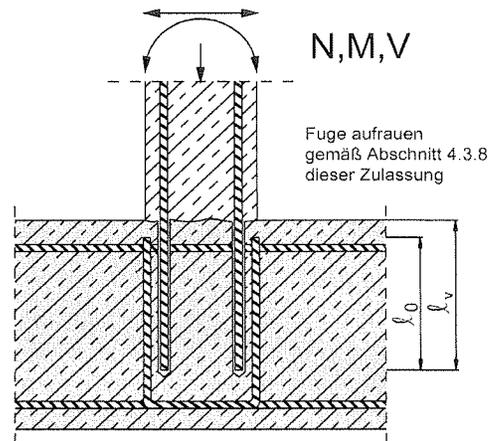
**Bild 3: Endverankerung von Platten oder Balken**
