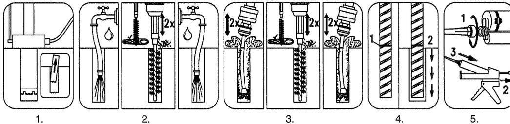
1. Bohrloch mit Diamantbohrer erstellen. Bohrerdurchmesser siehe Anhang 6, Tabelle 5. Bohrkern vollständig entnehmen.
