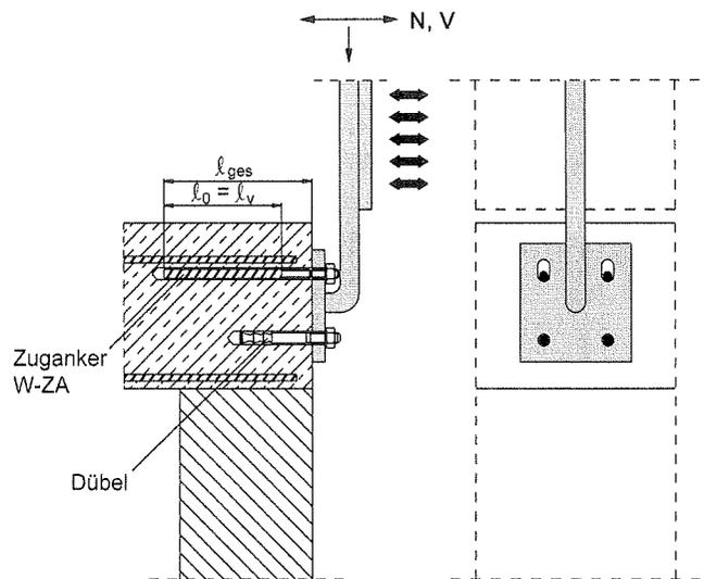
**Bild 8: Übergreifungsstoß für die Verankerung von auskragenden Bauteilen**
