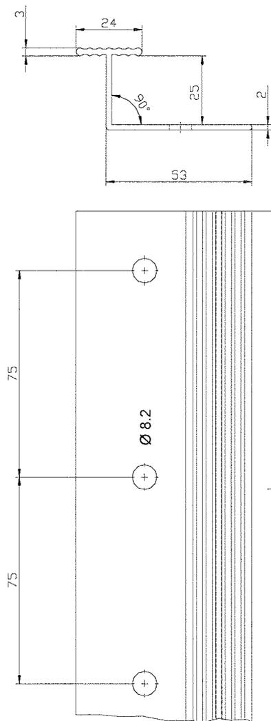
**Vertikales Verbindungsprofil – "Verbindungsleiste PVC" (Maße in mm)**
