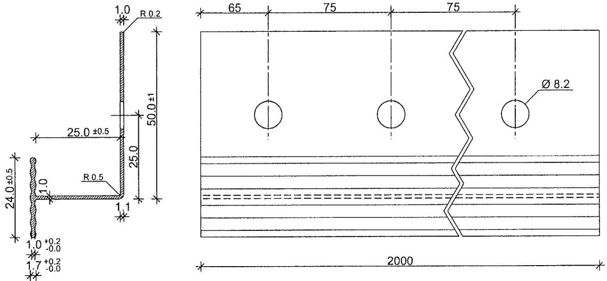
**Vertikales Verbindungsprofil "Brillux WDVS Alu-Verbindungsleiste 3580"**
