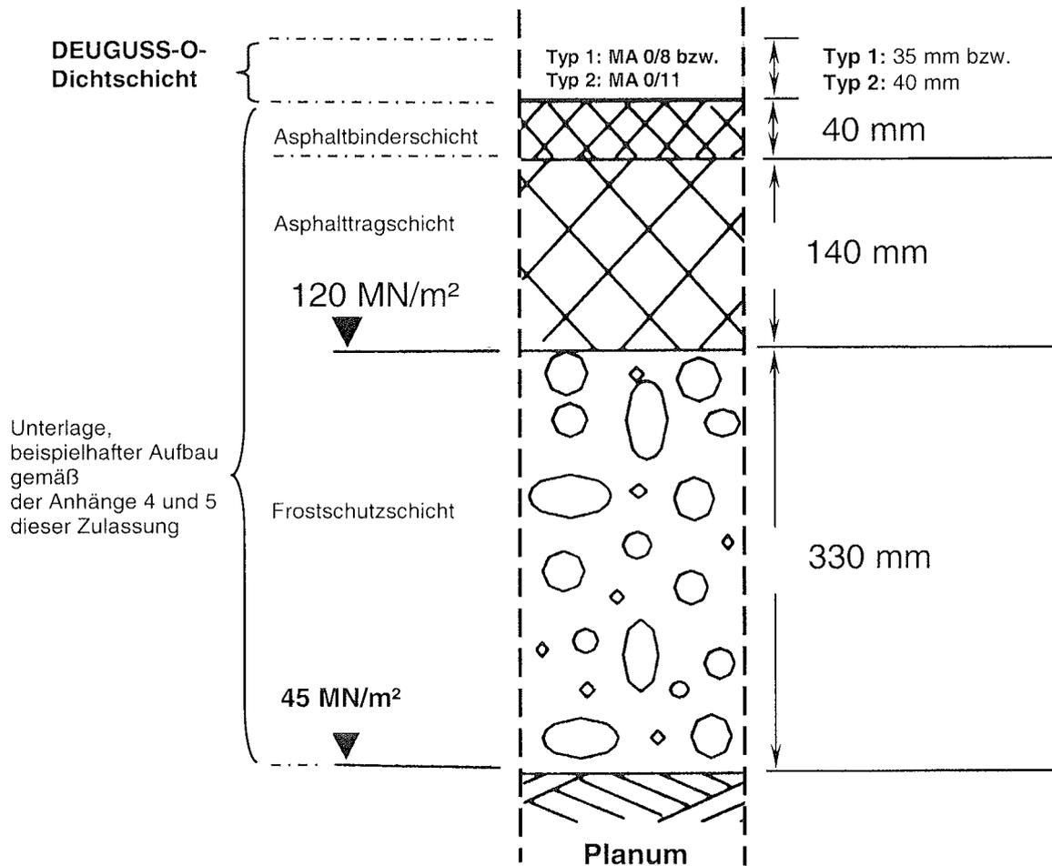
Der Dichtheitsnachweis der Dichtschicht ist für das jeweilige Objekt durch Eindringprüfung mit der Referenz-Prüfflüssigkeit nach Anhang 4 zu erbringen.
