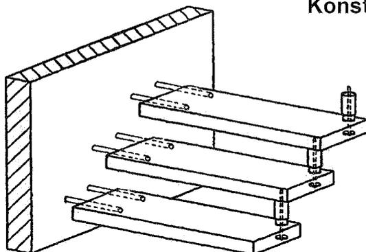
zwischen den Trittstufen darf zusätzlich eine Setzstufe angeordnet werden (entsprechend technischer Dokumentation und Anhang 2)
