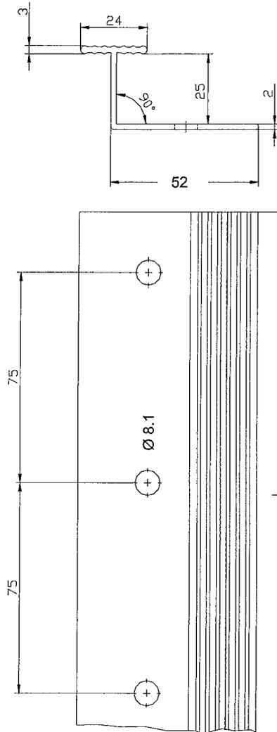
**Vertikales Verbindungsprofil "Duroflex PVC Verbindungsschiene" (Maße in Millimetern)**
