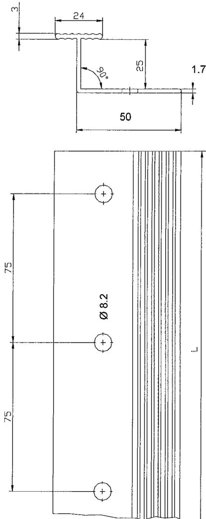
**Vertikales Verbindungsprofil – "GIMA-Verbindungsschiene für WDV-System Polytherm"**
