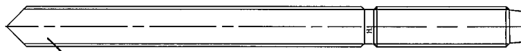
Gewindestange HAS-(E) ... Größen M8, M10, M12, M16, M20, M24, M27 oder M30
