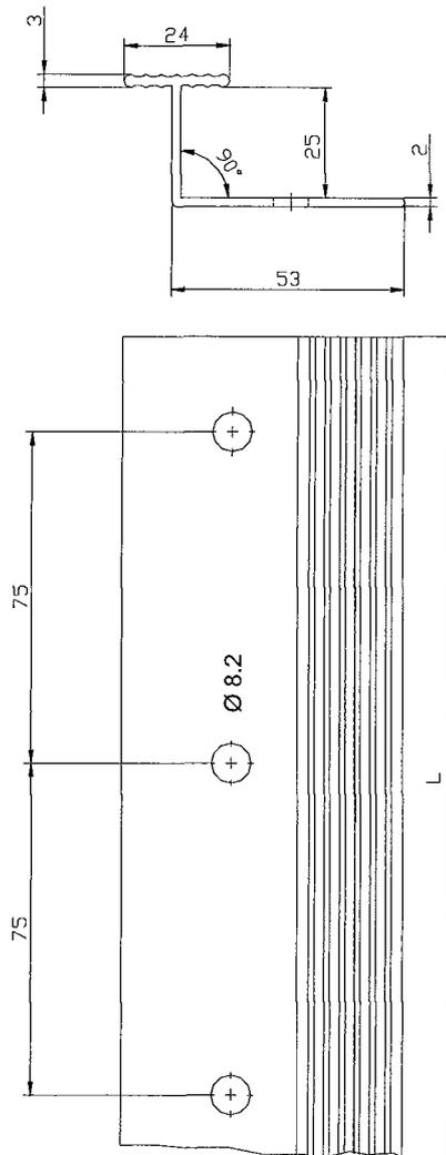
**Vertikales Verbindungsprofil – "PVC-Verbindungsleiste" (Maße in mm)**
