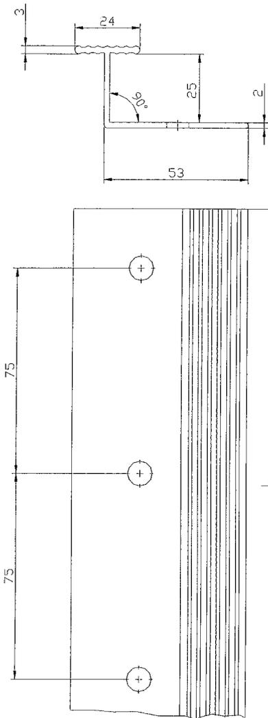
**Vertikales Verbindungsprofil "RESOTHERM Verbindungsleiste" (Abmessungen in mm)**
