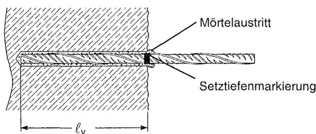
Nach dem Setzen des Bewehrungsstabes muss der Ringspalt vollständig mit Mörtel ausgefüllt sein.
