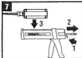
**Kassette mit dem Foliengebinde in das Auspressgerät einlegen.** Entriegelungstaste drücken, Vorschubstangen zurückziehen und Kassette mit Foliengebinde in das passende Hilti Auspressgerät einlegen.
