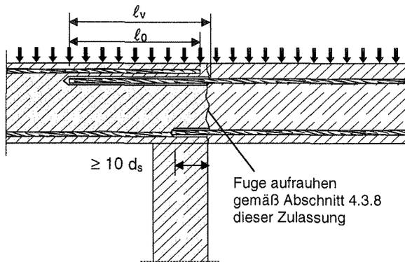
**Bild 2:** Übergreifungsstoß einer biegebeanspruchten Stütze oder Wand an ein Fundament
