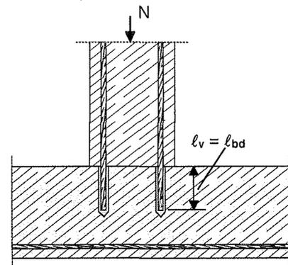
**Bild 5:** Verankerung von Bewehrung zur Abdeckung der Zugkraftlinie
