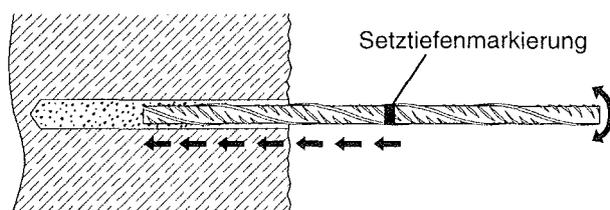
Zur Erleichterung der Installation den Bewehrungsstab mit hin und her drehender Bewegung in das verfüllte Bohrloch bis zur Setztiefenmarkierung einführen.
