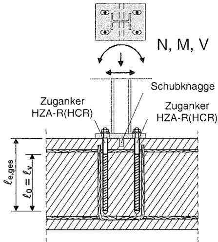
**Bild 7:** Übergreifungsstoß für die Verankerung von Geländerpfosten
