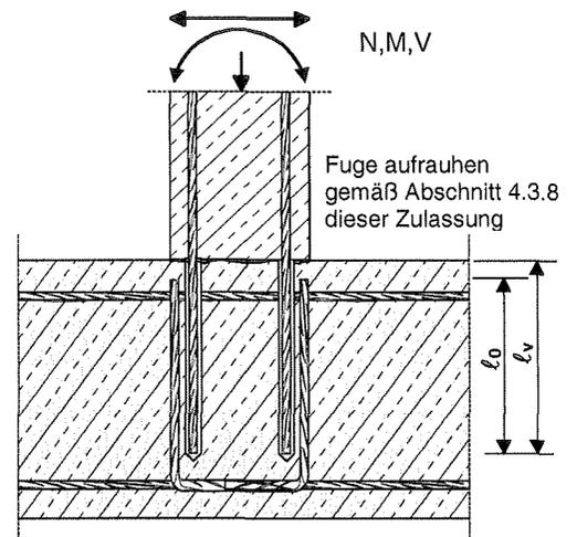
**Bild 3:** Endverankerung von gelenkig gelagerten Platten oder Balken
