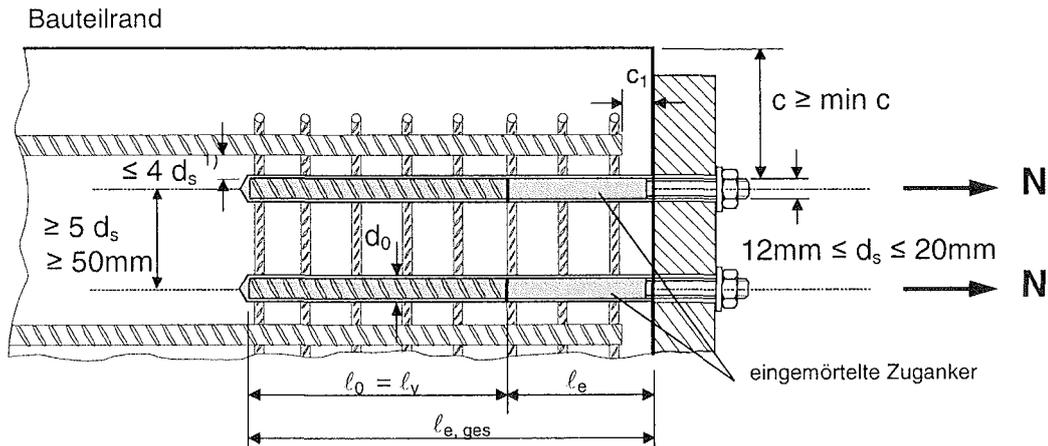
1) Ist der lichte Abstand der gestoßenen Stäbe größer als  $4d_s$ , so muss die Übergreifungslänge um die Differenz zwischen dem vorhandenen lichten Stababstand und  $4d_s$  vergrößert werden.
