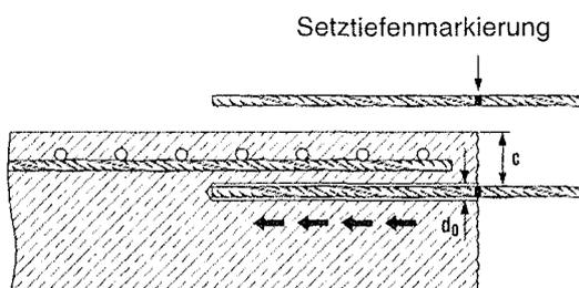
Vor dem Gebrauch sicherstellen, dass der Bewehrungsstab trocken und frei von Öl oder anderen Verunreinigungen ist.
