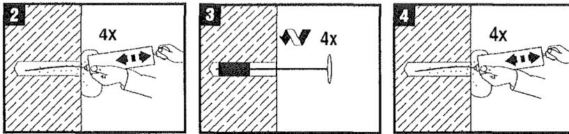
Alternativ zur Pressluftreinigung ist bei hammergebohrten Bohrlochern die Handreinigung bis Bohrdurchmesser  $d_0 \leq 20\text{mm}$  und Bohrtiefen  $l_v$  bzw.  $l_{e,ges.} \leq 250\text{mm}$  erlaubt.
