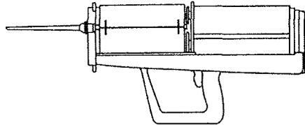
**Hilti HIT-P8000D** Pneumatisches Auspressgerät (1400 ml)
