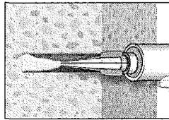
**6** Gereinigtes Bohrloch vom Bohrlochgrund her ca. zu 2/3 mit Verbundmörtel befüllen. Langsames Zurückziehen des Statikmischers aus dem Bohrloch verhindert die Bildung von Luftporen. Für Setztiefen größer 190 mm passende Mischerverlängerung verwenden. Für die Horizontal- oder Überkopfmontage von Anker > Ø 20 mm sind Verfüllstützen gemäß Anhang 8 zu verwenden. Die temperaturrelevanten Verarbeitungszeiten (Tabelle 4) sind zu beachten.
