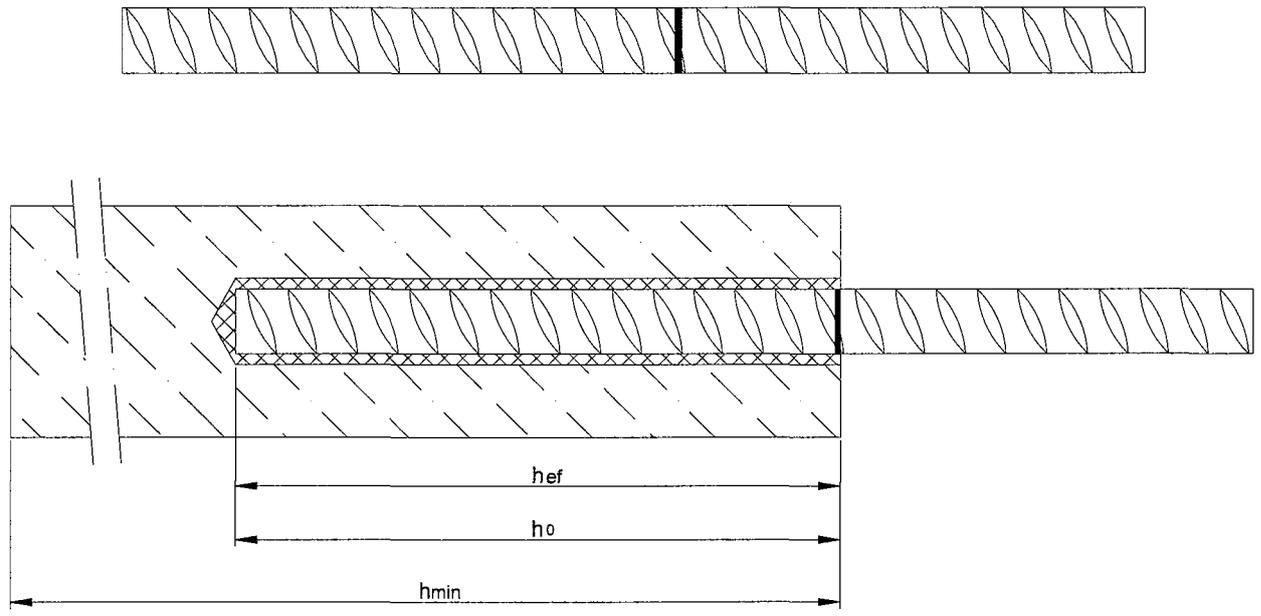
Chemofast Injektionssystem STVK/ALVK in Beton
