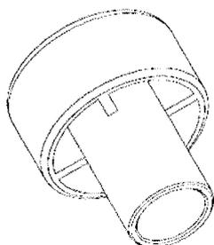
**Verfüllstutzen für Überkopf- oder Horizontalmontage**
