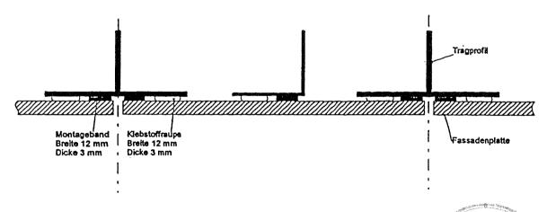
Konstruktionsbeispiele für Fassadenplatten und Tragprofile der Unterkonstruktion (Breite des Tragprofils: 40 - 80 mm)
