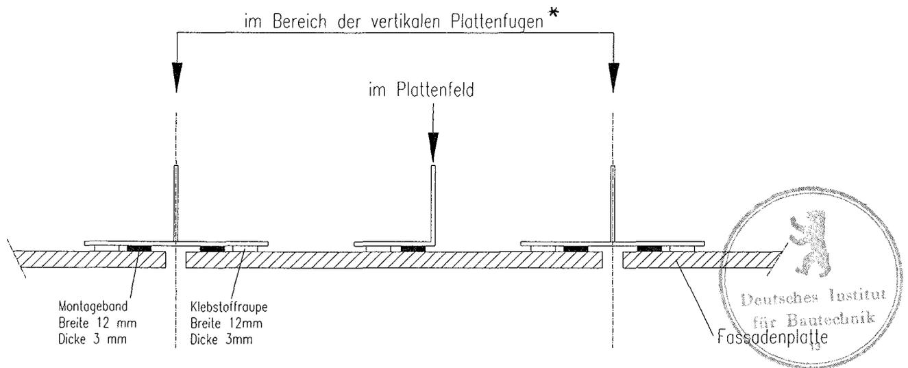
\* Aufgrund des im Einzelfall durchzuführenden Standsicherheitsnachweises kann es erforderlich sein, benachbarte Platten auf zwei separate Tragprofile zu befestigen.
