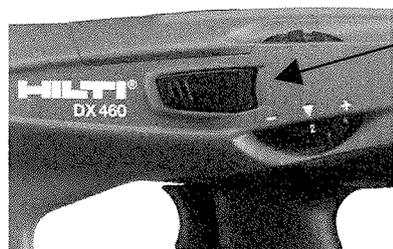
Drehrad für Setzenergieeinstellung am Bolzensetzgerät DX 460 F8 (MX)
