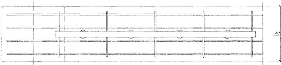
Abstände  $S_{L, PSB}$  der PSB-S-Anker in Richtung der Biegebeanspruchung nach Tabelle 1. Bei Balken mit  $h < 20$  cm und  $V_{Ed} < 0,3 V_{Rd, max}$  braucht der Abstand nicht kleiner als 15 cm zu sein.
