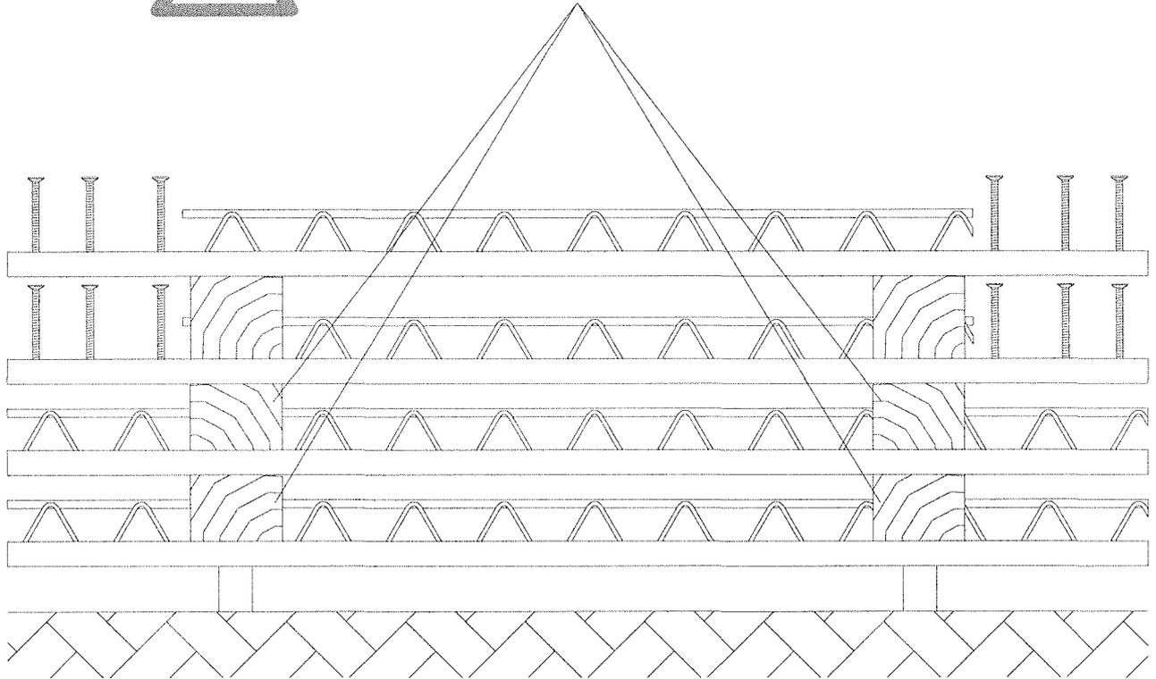
Beim Lagern und Transportieren von Elementdecken sind die PSB-S-Querkraftbewehrungen zu beachten, die aufgrund ihrer Höhe über die Gitterträger hinausragen. Die zur Auflagerung der Elementdecken erforderlichen Distanzhalter sind entsprechend zu erhöhen.
